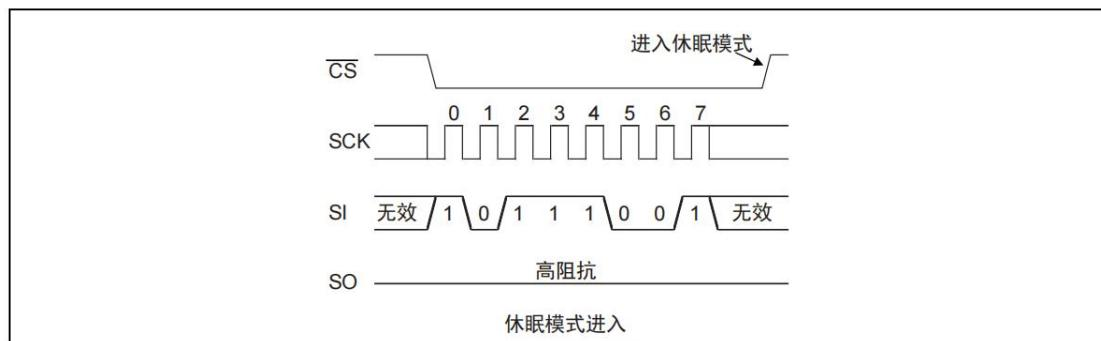
在  $\overline{CS}$  下降沿之后的  $t_{REC}$  (最大 1 微秒) 时间内，芯片将退出 睡眠模式。
