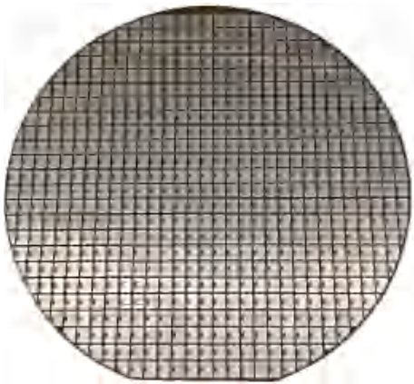
JSAB 1200V-16mohm 车规级 SiC MOSFET晶圆
